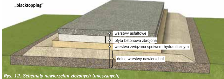
Rys. 12. Schematy nawierzchni złożonych (mieszanych)
