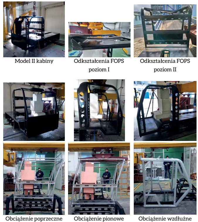
Rys. 8. Przebieg badania FOPS i ROPS kabiny stalowej oraz ROPS kabiny aluminiowej
