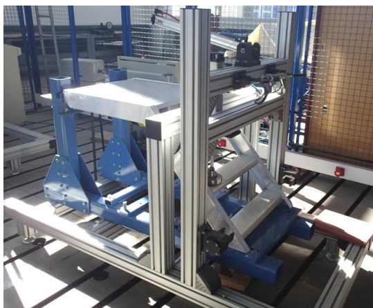
Rys. 3. Stanowisko do badań cyklicznych elementów rusztowań budowlanych
