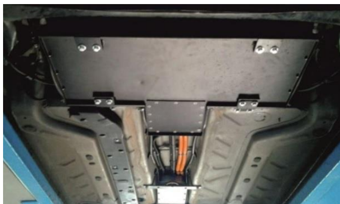
Rys. 2. Pakiet akumulatorów zamontowany pod podłogą [8]
