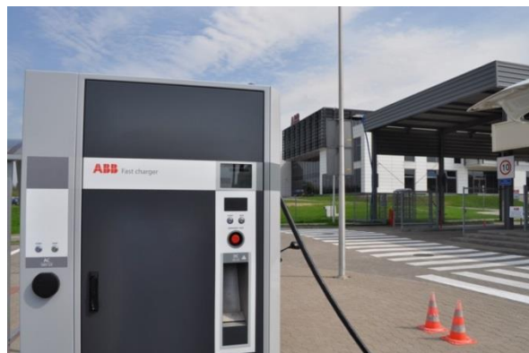
Rys. 6. Szybka ładowarka ABB Terra 52- 50 kW DC CHAdeMO [15]
