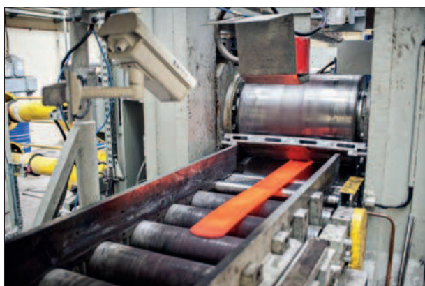
Rys. 4. Walcowanie pasma płaskiego
