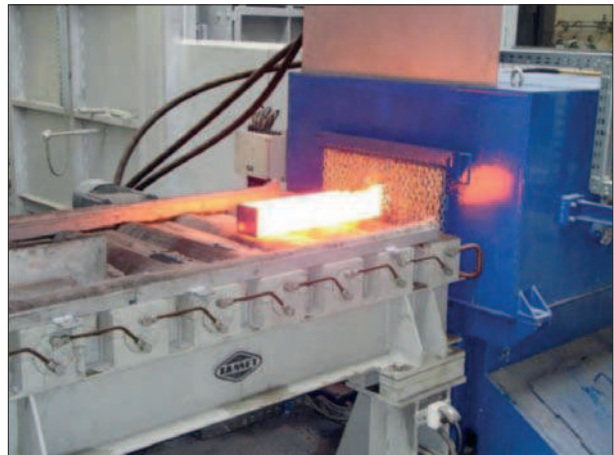
Rys. 1. Hydrauliczny zbijacz zgorzeliny modułu B-LPS Fig. 1. Hydraulic scale breaker of the B-LPS module
