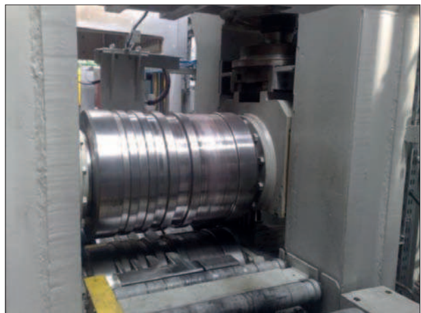
Rys. 2. Walcarka modułu B-LPS ze złożeniem walców z wykrojami skrzyńkowymi Fig. 2. Rolling mill of the B-LPS module with assembly of box-pass rollers
