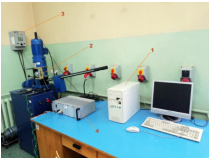
Rys. 9. Aparat czterokulowy T-02 z dodatkowymi urządzeniami. 1 — komputer z oprogramowaniem sterującym, 2 — aparat czterokulowy T-02, 3 — regulator SM-303, 4 — mikroprocesorowy sterownik tribologiczny
