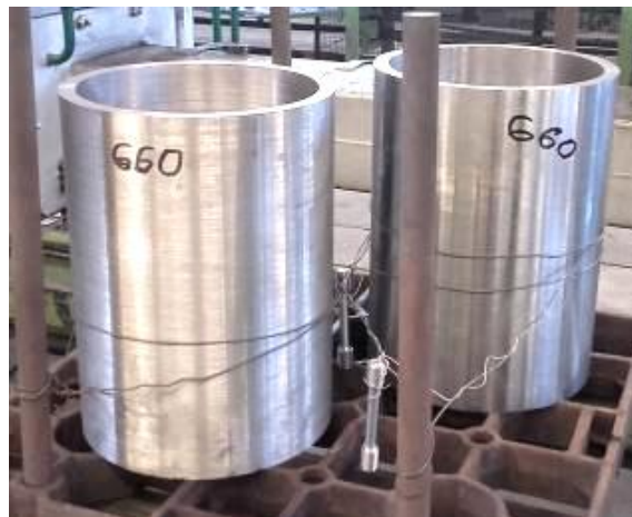
Rys. 1. Fotografie tulei testowych podczas ulepszenia cieplnego
