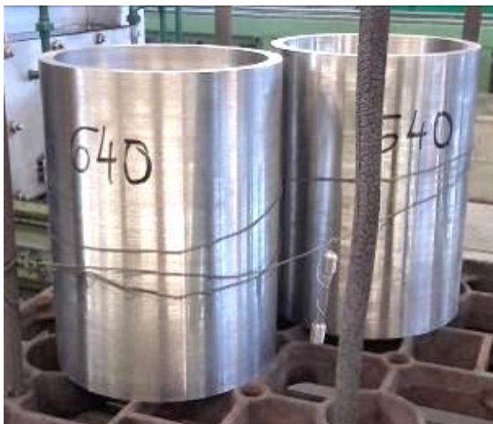
Rys. 1. Fotografie tulei testowych podczas ulepszenia cieplnego
