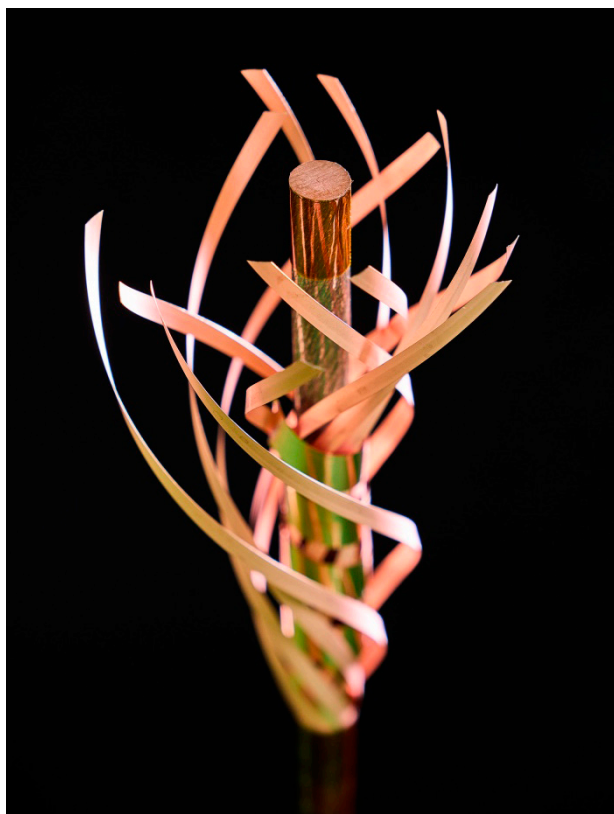
Fot. 1. CERN: Wysokotemperaturowy nadprzewodzący (HTS) kabel przesyłowy z tlenkiem baru i miedzi ziem rzadkich (określany również, jako REBCO) używany w CERN
