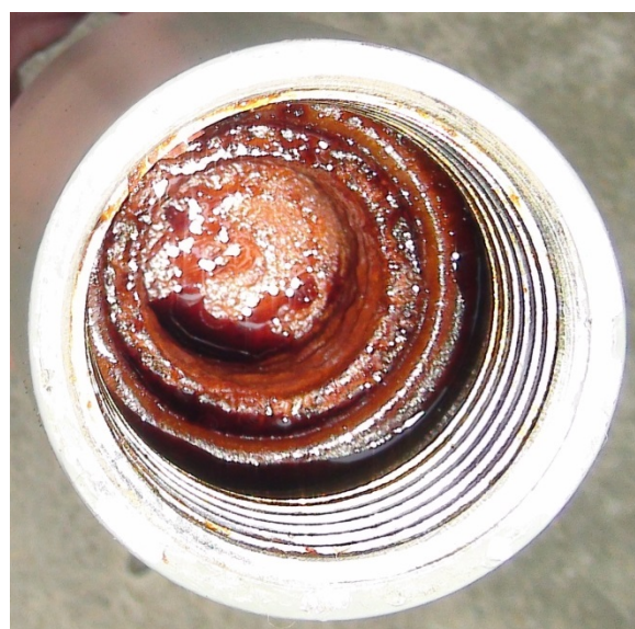
Fot. 5. Głowica pocisku odłamkowego z zaolejonym TNT [7]
