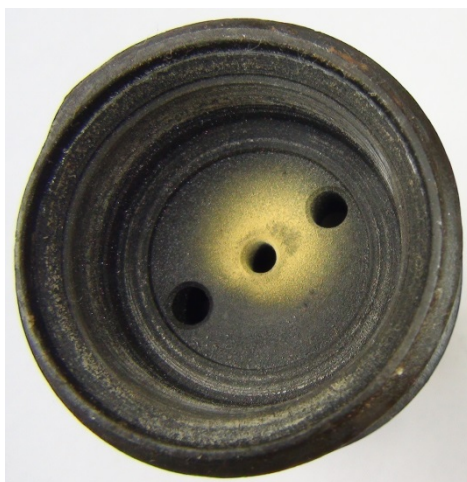
Fot. 1. Wypylony materiał wybuchowy wokół kanału ogniowego, w korpusie zapalnika artyleryjskiego [7]
