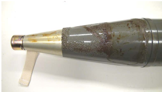
Fot. 3. Olej trotylowy na zewnętrznej powierzchni pocisku zawierającego TNT [7]
