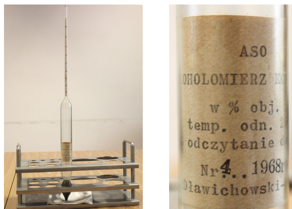
Rys. 4. Widok alkoholomierza kontrolnego nr 4 wytwórcy R. Dławichowski
