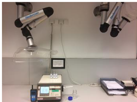
Rys. 12. Stanowisko pomiarowe przeznaczone do wzorcowania gęstościomierzy oscylacyjnych
