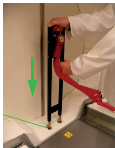
Rys. 3 Narzędzie do kontroli odstępów montowane do urządzenia Gamma Knife Perfexion®. Zieloną kreską oznaczono miejsce montowania urządzenia Źródło: [4].
