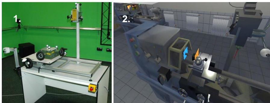
Rys. 1. Symulator wirtualnej kombinowanej maszyny (tokarko-frezarko-wiertarki) wyposażony w rzeczywiste (1) i wirtualne (2) elementy sterownicze
