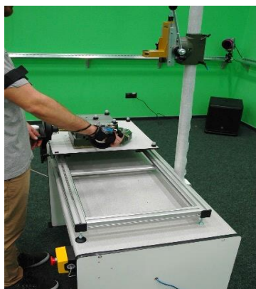
Rys. 3. Badanie symulowania wrażenia odczucia dotyku przy użyciu symulatora wyposażonego w rzeczywiste elementy sterownicze i zwykłą rękawicę VR
