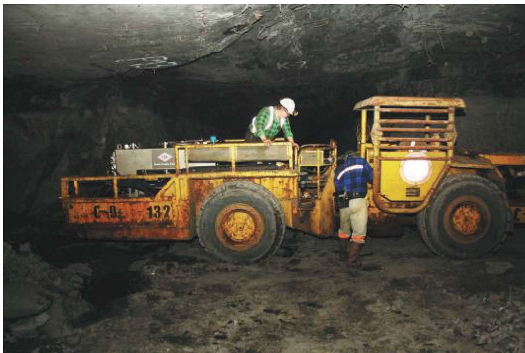
Rys. 2. Samojezdny wóz transportowy do przewozu materiałów wybuchowych Fig. 2. Power truck for transporting explosives
