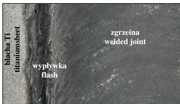
Rys. 8. Zgrzeina nr 4 – powierzchnia lica
