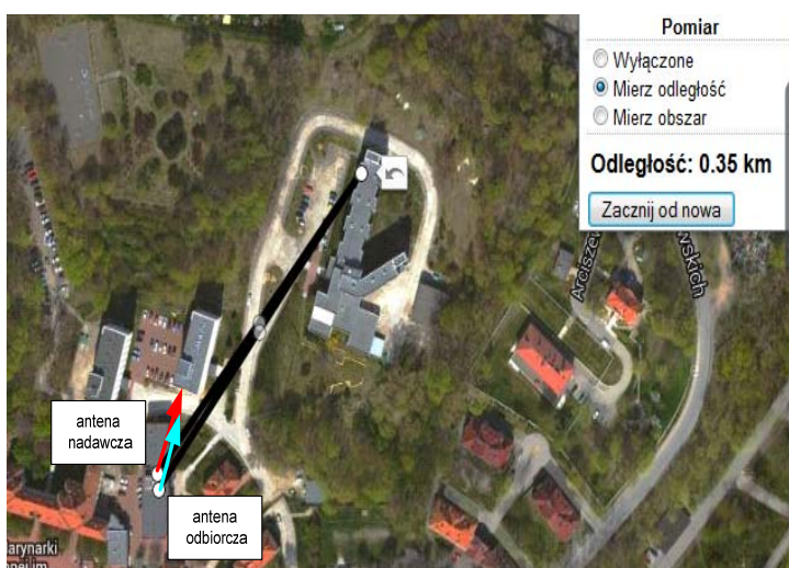
Rys. 5. Orientacyjne wyznaczenie trzeciej drogi propagacji sygnału z anteny nadawczej do odbiorczej
