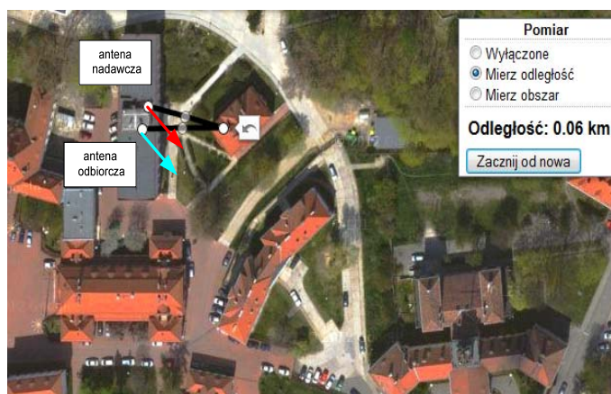
Rys. 8. Orientacyjne wyznaczenie drugiej drogi propagacji sygnału z anteny nadawczej do odbiorczej
