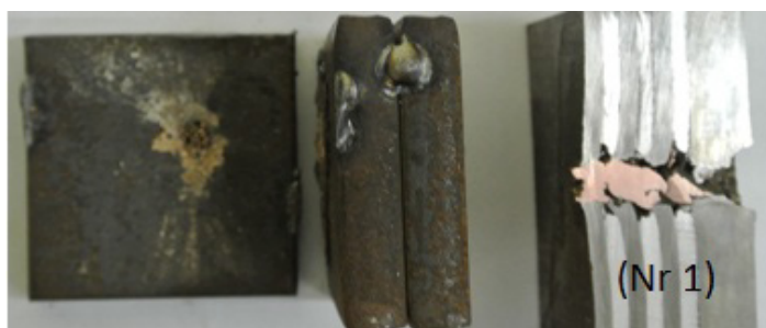
Rys. 8. Działanie strumienia kumulacyjnego w stronę warstwy Ti 10 mm: dodatkowe przebicie 3 płytek kontrolnych; układ strzelania Nr 1 (jak na rys. 3b)
