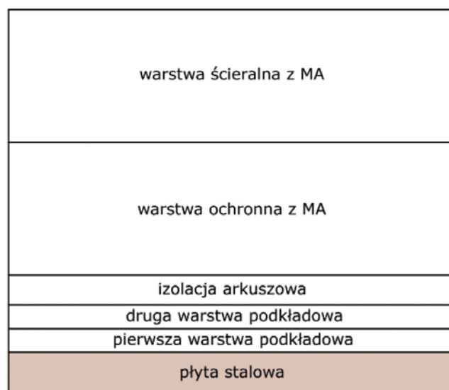
Rys. 3. Przykładowe rozwiązania nawierzchni mostowej na płycie betonowej (z lewej) i stalowej (z prawej) w Niemczech (opr. własne na podst. [3])
