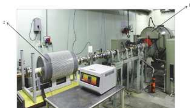
Fot. 1. Układ do napromieniowania wysokotemperaturowego: 1 – akcelerator elektronów Van de Graaff AS 2000; 2 – wysokotemperaturowy piec oporowy Carbolite (UK) Photo 1. A system for high-temperature irradiation: 1 – The Van de Graaff electron accelerator AS 2000; 2 – High temperature Carbolite furnace (UK)
