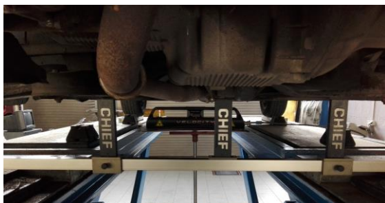
Rys.11 Widok zamontowanej bramki pomiarowej do analizy górnych punktów podparcia zawiesznień
