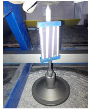
Rys.9 Widok tarczy pomiarowej do identyfikacji położenia dolnego przegubu zawieszenia
