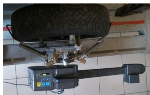
Rys.15 Widok kamery pomiarowej umieszczonej na kole
