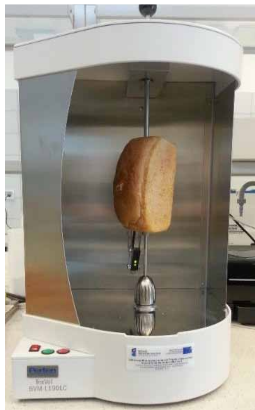
Rys. 10. Obiętościomierz laserowy TexVolBVM – L190LC Firmy Perten Instruments AB [12].
