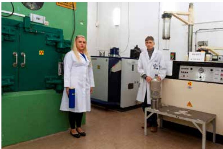
Ryc. 1 Kobaltowe źródła promieniowania gamma o różnej mocy dawki stosowane między innymi do badań radiolizy materiałów w ciekłym azocie. W przypadku kolagenu zastosowano źródło hinduskiej produkcji znajdujące się w środku (moc dawki 2 kGy/h)
