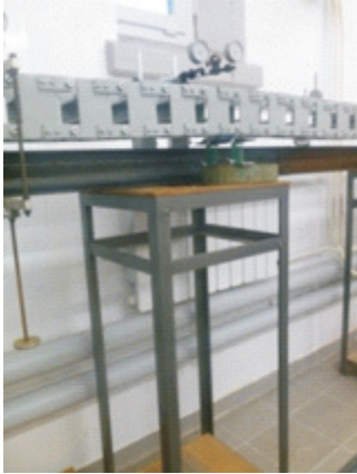
Rys. 2.5. a) Stojak pod model; b) zegarowy czujnik przemieszczeń na statywie z podstawą magnetyczną
