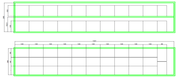
Rys. 15. Przykład rozmieszczenia palet EURO w dwupoziomym systemie załadunku
