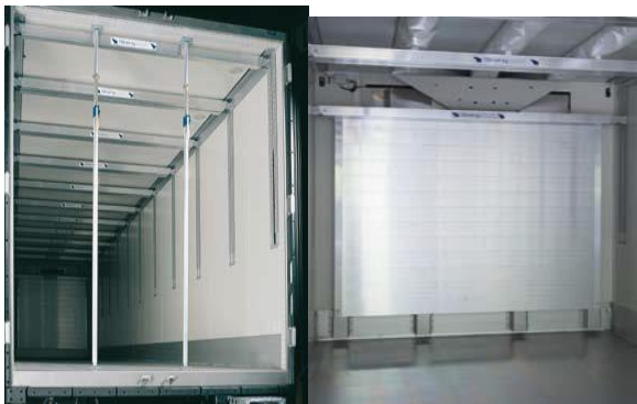
Rys. 18. Srodki techniczne zabezpieczenia ładunku naczepy Schmitz Cargobull od lewej: paleta stop, podłoga z aluminiowej blachy ryflowanej zwiększająca współczynnik tarcia, połączona z cokołowymi listwami na ścianach bocznych, teleskopowe blokady ładunku z gumowymi stopkami.
