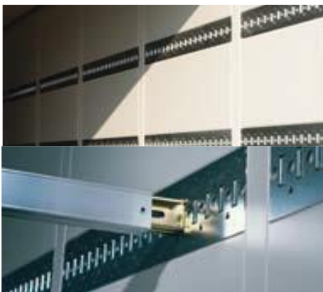
Rys. 19. Szyny zabezpieczające ładunek w ścianie bocznej
