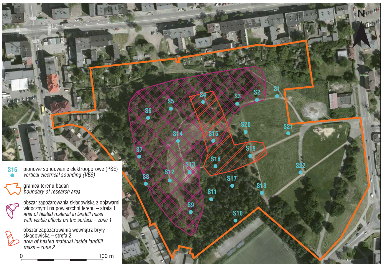
Ryc. 8. Wizualizacja zasięgu procesów pożarowych w składowisku odpadów pokopalnianych w Chorzowie (październik 2015 r.) Fig. 8. Visualization of the thermally active area within the spoil heap in Chorzów (October 2015)
