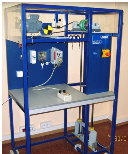
Fot. 3 Stanowisko „Sterowanie napędami elektrycznymi (wciągarka)”
