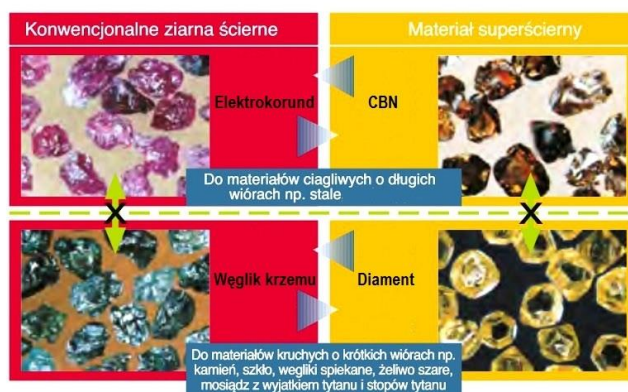
Rys. 3. Ogólne zalecenia odnośnie zastosowań ścierniwi z diamentu, regularnego azotku boru (CBN), elektrokorundu i węglika krzemu [9]
