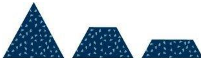
Rys. 7. Schemat zachowania się w trakcie obróbki tzw. nasypów diamentowych o budowie strukturalnej [22]
