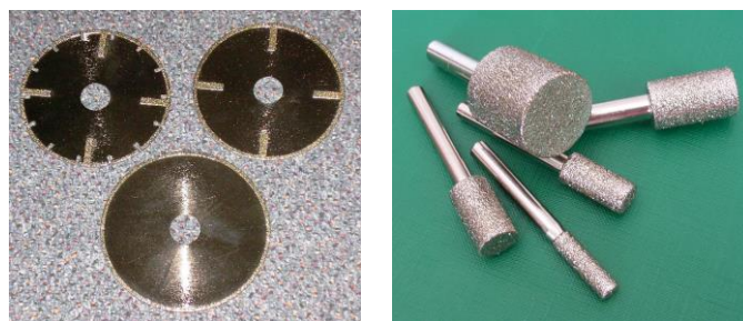
Rys. 5. Przykłady pił do cięcia i frezów do obróbki kompozytów stosowanych w produkcji kadłubów samolotów i łodzi oraz materiałów hamulcowych
