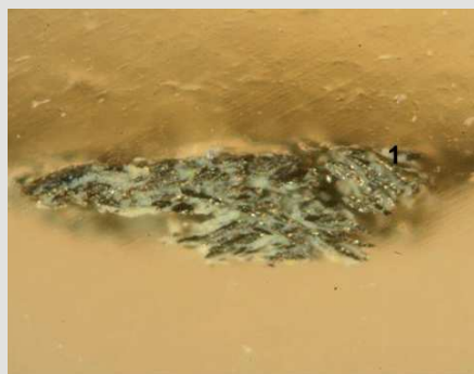
Fot 1. Karnacja – złota farba na blasze. Warstwa 1, metaliczna biała: brąza, biel tytanowa TiO 2 , biel cynkowa ZnO, kreda CaCO 3 , spoiwo akrylowe
