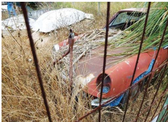
Fot. 1. Nielegalnie składowane wraki samochodowe zawierające części azbestowe [20]
