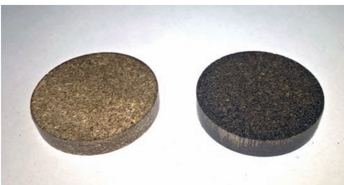
Rys. 2. Sprasowane pastylki biomasy, od lewej – słoma i słonecznik
