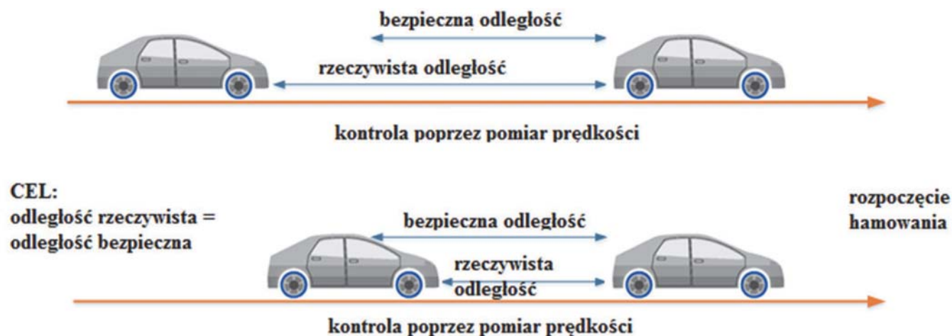
Rys. 4. Zasada działania systemu ACC
