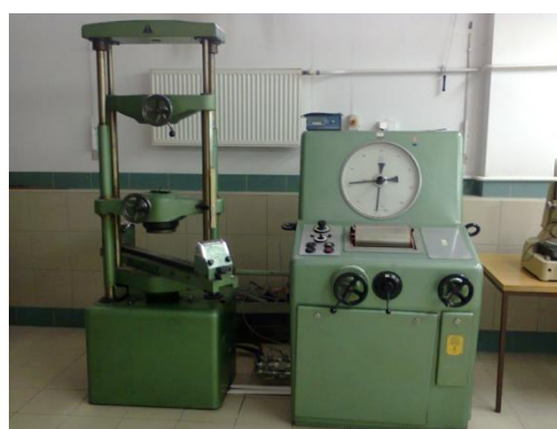
Rys. 1. Przykład zmodernizowanej maszyny wytrzymałościowej
