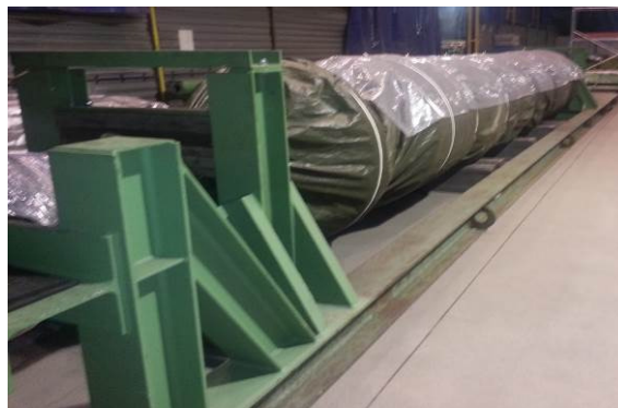
Rys. 2 Zdjęcia przedstawiają zabezpieczony wirnik przed wysyłką do klienta [2]
