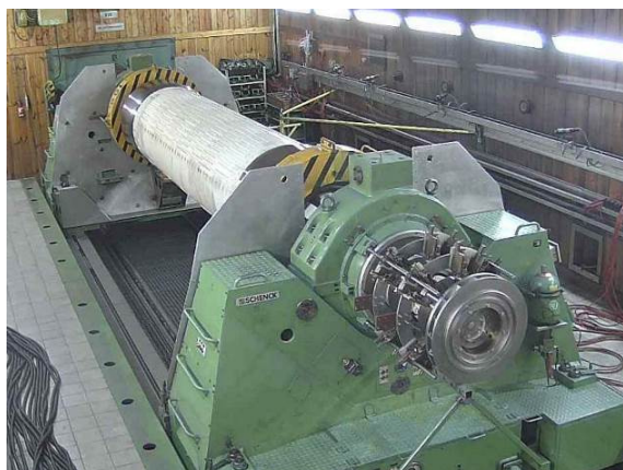
Rys. 7. Zdjęcie przedstawia wirnik generatora synchronicznego podczas badań [2]
