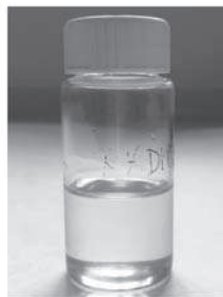
Rys. 3. Otrzymany poli(tlenek propylenu), w postaci żelu do badań dozymetrycznych
