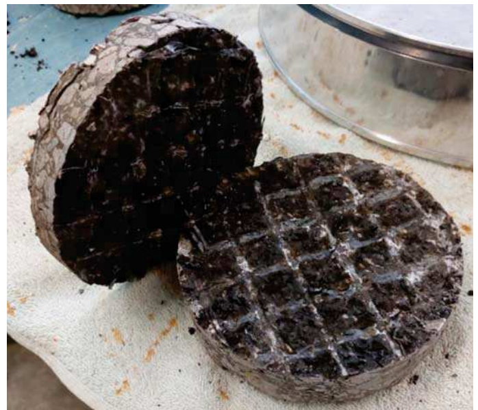
Fot. 6. Ścięta próbka wariantu „4+2” z siatką nr 2
