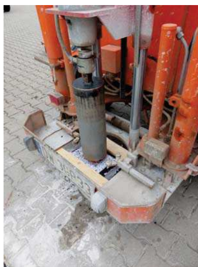
Fot. 4. Wycinanie rdzenia \phi 150 mm z próbki płytowej (K. Żołnowski)
