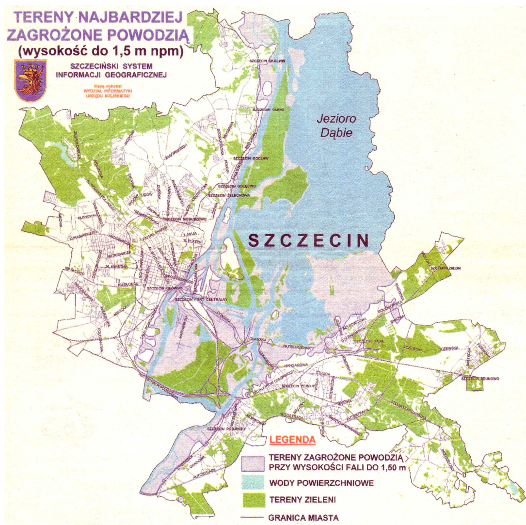
Rys. 10. Zobrazowanie symulacji zalania terenów portu i miasta podczas powodzi w 1997 roku przy prognozowanej wysokości fali - sporządzone przy wykorzystaniu SSIG [3]
