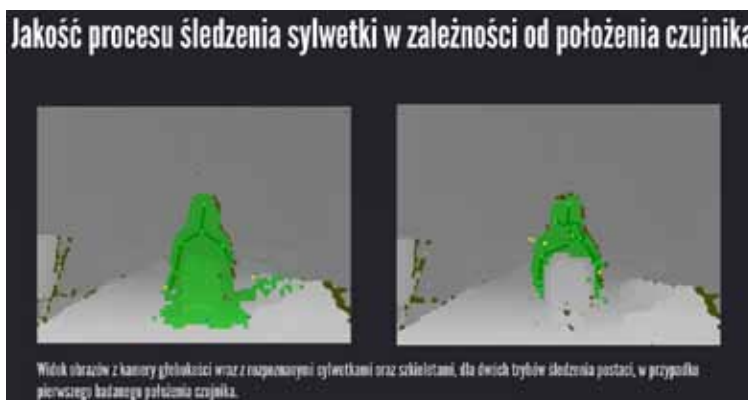
Rys. 12 Jakość rozpoznawania szkieletu postaci Operatora w różnych pozycjach pracy.
