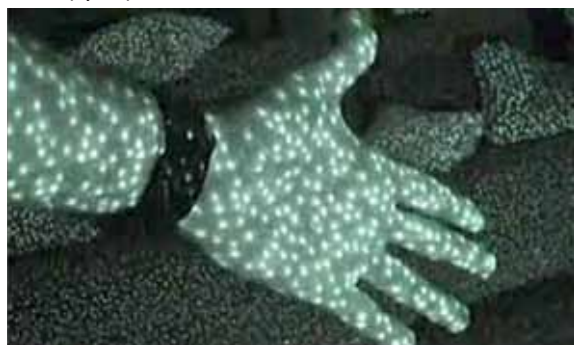
Rys. 7 Ilustracja zasady działania sterownika Kinect.
