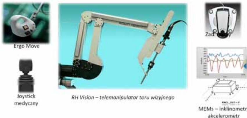
Rys. 1 Zestawienie rozwiązań systemów zadawania pozycji lub prędkości telemanipulatorów Robin Heart.
