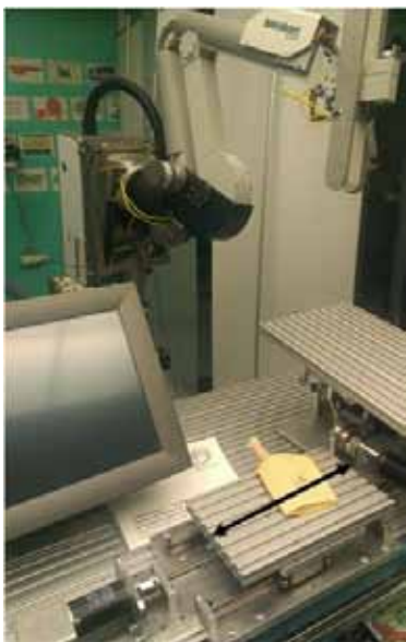
Rys. 10. Stanowisko precyzyjnego zadawania pozycji fantomu palca dla sterowania RH Vision.
