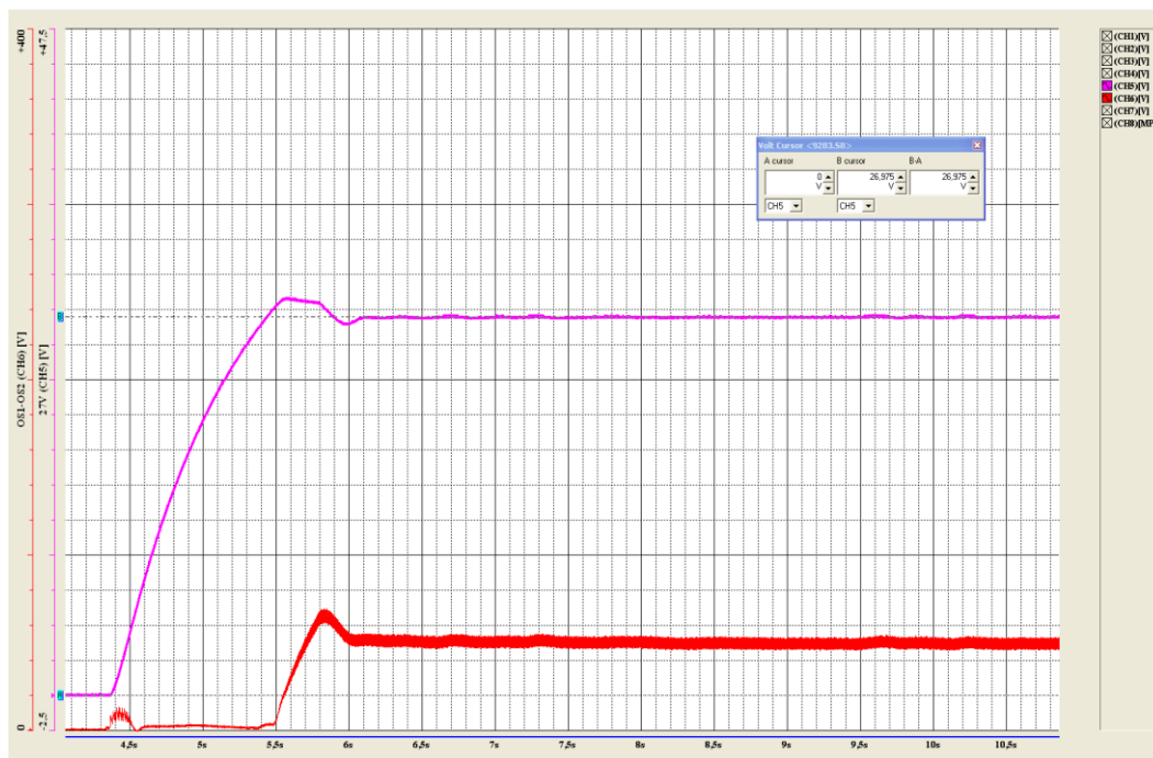
Rys. 14. Zapis pomiarów z badań turbogeneratora nr 92831 po 9,5h pracy (27V i napięcie zmieniające oporność magnetyczną twornika).
