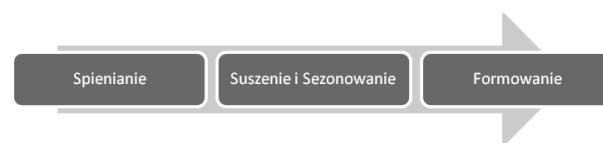
Rys. 1. Schemat produkcji spienionego polistyrenu
