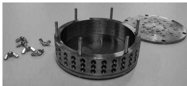
Rys. 2. Forma do wykonania próbek
