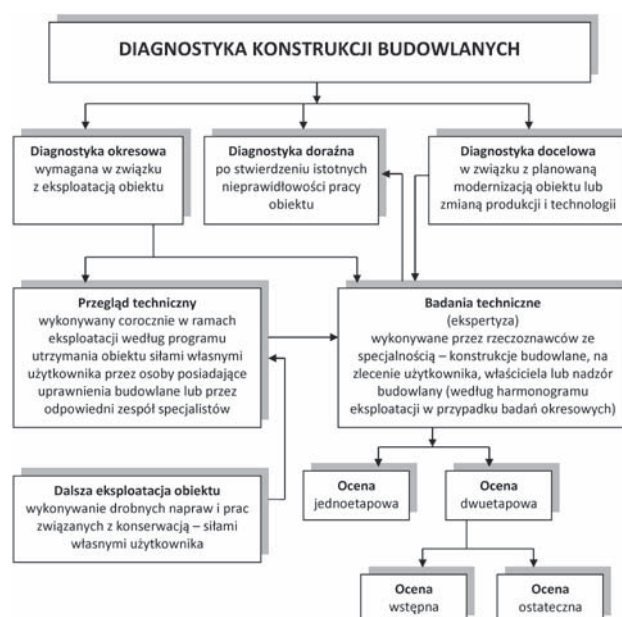
Rys. 1. Systemy diagnostyk konstrukcji budowlanych [7].
