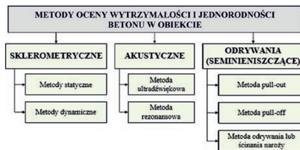
Rys. 5. Metody nieniszczące i seminieniszczące stosowane do oceny wytrzymałości i jednorodności betonu w konstrukcjach budowlanych [6].
