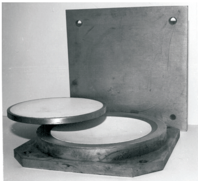
Fot. 6. Prototyp łożyska soczewkowego wielokierunkowo-przesuwne- go opracowany w IBDiM w latach 80. [16]
