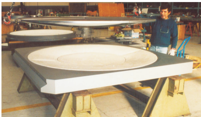
Fot. 8. Płyta dolna największego w Polsce łożyska soczewkowego o nośności 110 MN (łożysko jednokierunkowo-przesuwne) (ze zbioru autora)
