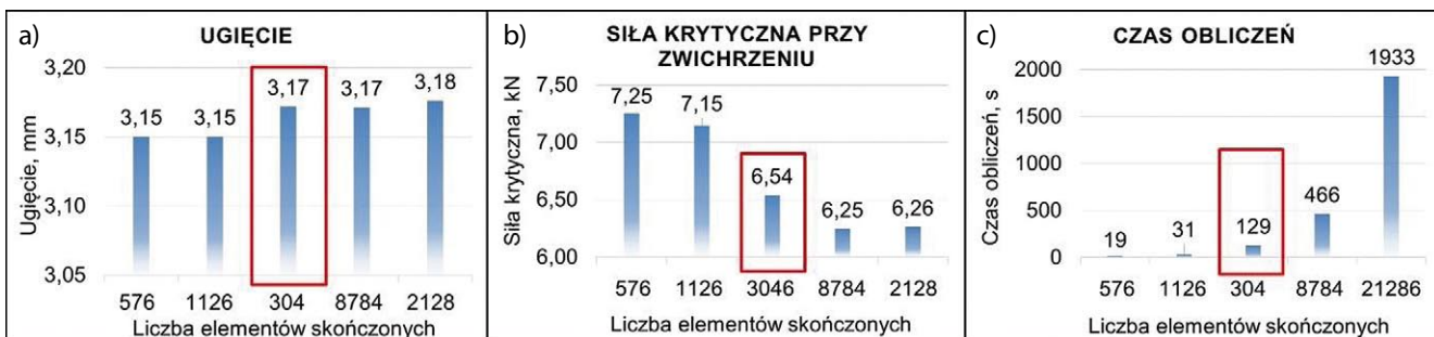
Rys. 5. Wpływ liczby elementów skończonych przy zastosowaniu 27-węzłowych elementów 3D-solid na: a) ugięcie, mm, b) siłę krytyczną przy zwężeniu, kN, c) czas obliczeń, s
