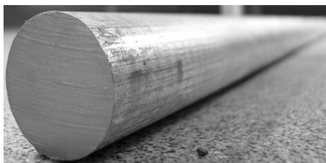
Rys. 6. Przykładowy widok aluminiowego wlewka ciągłego o średnicy 30mm
