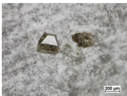
Rys. 9. Analiza mikroskopowa tarczy prototypowej na spoiwie z żywicy epoksydowej przy powiększeniu 50\times .
