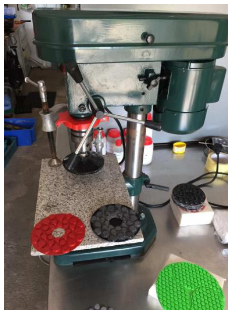
Rys. 6. Autorskie stanowisko do badań efektywności ściernej nowych rozwiązań konstrukcyjno-materiałowych tarcz szlifierskich.
