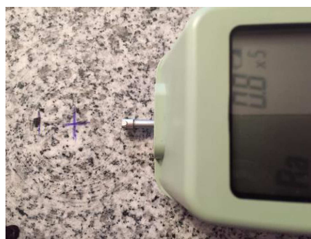
Rys. 7. Pomiar rozkładu chropowatości.
