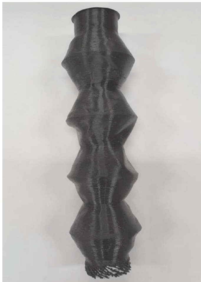
Rys. 8. Próbką po wykonaniu 5000 cykli, która nie uległa uszkodzeniu
