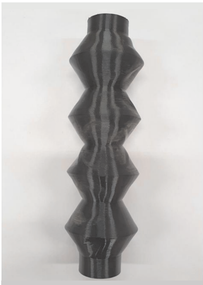
Rys. 7. Próbką po wykonaniu 5000 cykli, która nie uległa uszkodzeniu
