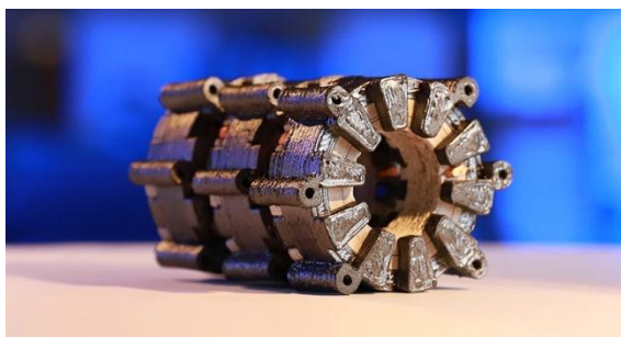
Rys. 3. Pierwszy silnik elektryczny wydrukowany metodą druku wielomateriałowego [14]
