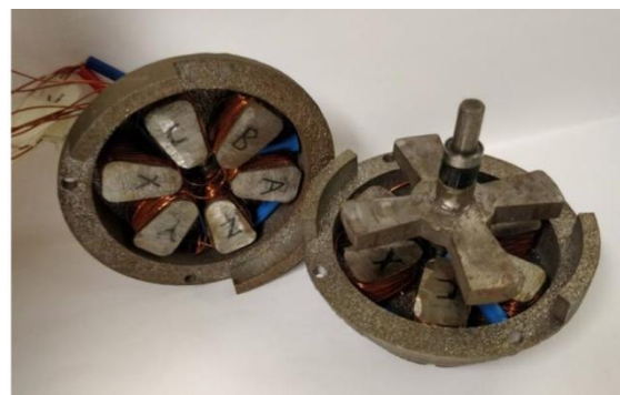
Rys. 4. Silnik reluktancyjny wydrukowany w technologii SLM [9]
