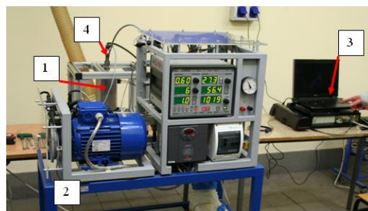
Rys. 1. Widok stanowiska badawczego: 1 – tuleja reakcyjna, 2 – stanowisko testowania pomp i wtryskiwaczy systemów Common Rail (STPiW-1), 3 – komputer z systemem pomiarowym PULSE – 3560C, 4 – wtryskiwacz
