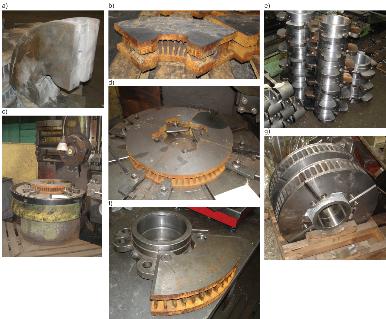
Rys. 4. Wybrane etapy z produkcji segmentowej tarczy hamulcowej BK 141 mocowanej na osi zestawu kołowego: a), b) odlewy segmentów tarczy dzielonej przed obróbką skrawaniem, c) segmenty tarczy zamocowane na tokarce karuzelowej, d) segmenty na stole tokarki karuzelowej ze wstępnie obrobioną powierzchnią cierną, e) piasta hamulcowa z obrobionymi powierzchniami przed wierceniem otworów montażowych, f) montaż segmentów do piasty hamulcowej za pomocą sworzni, g) zmontowane dwie tarcze hamulcowe [fot. W. Sawczuk]
