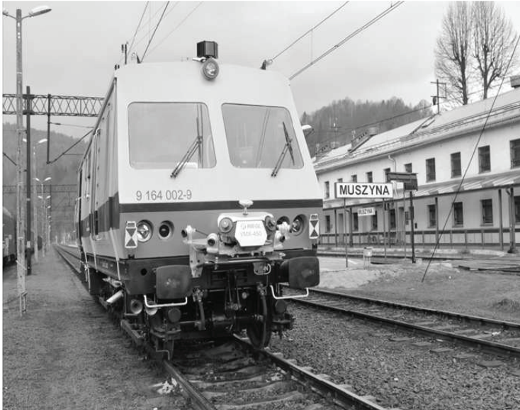
Rys. 3. Widok pojazdu EM-120 z zainstalowanymi urządzeniami pomiarowymi (widok z przodu) Źródło własne
