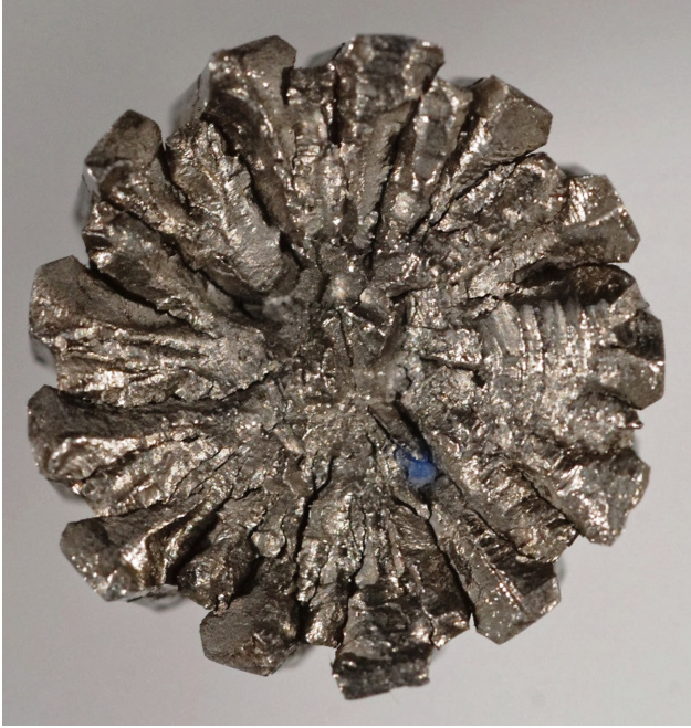
Rys. 3. Przełom części wału z wielowypustem z widocznymi pęknięciami idącymi od powierzchni dna wpustu prawie do osi wału; widoczne również „zaklepania” powierzchni przełomu.
