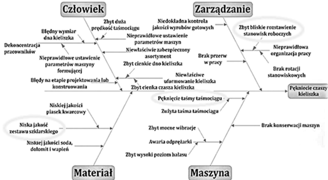
Rys. 13.2 Diagram Ishikawy dla problemu pęknięcie czaszy kieliszka
